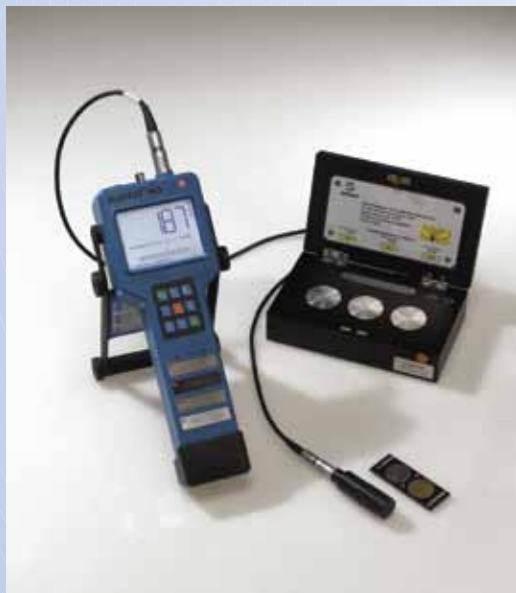
Leitfähigkeitsprüfung und Schichtdickenmessung mit dem ELOTEST M2 V3
