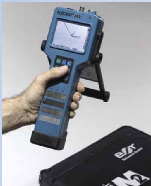
ELOTEST M2 V3 - entwickelt als "Einhandgerät" nach ergonomischen Empfehlungen der Arbeitsmedizin. Der Geräteschwerpunkt liegt in der Handfläche für langes, ermüdungsfreies Arbeiten.
