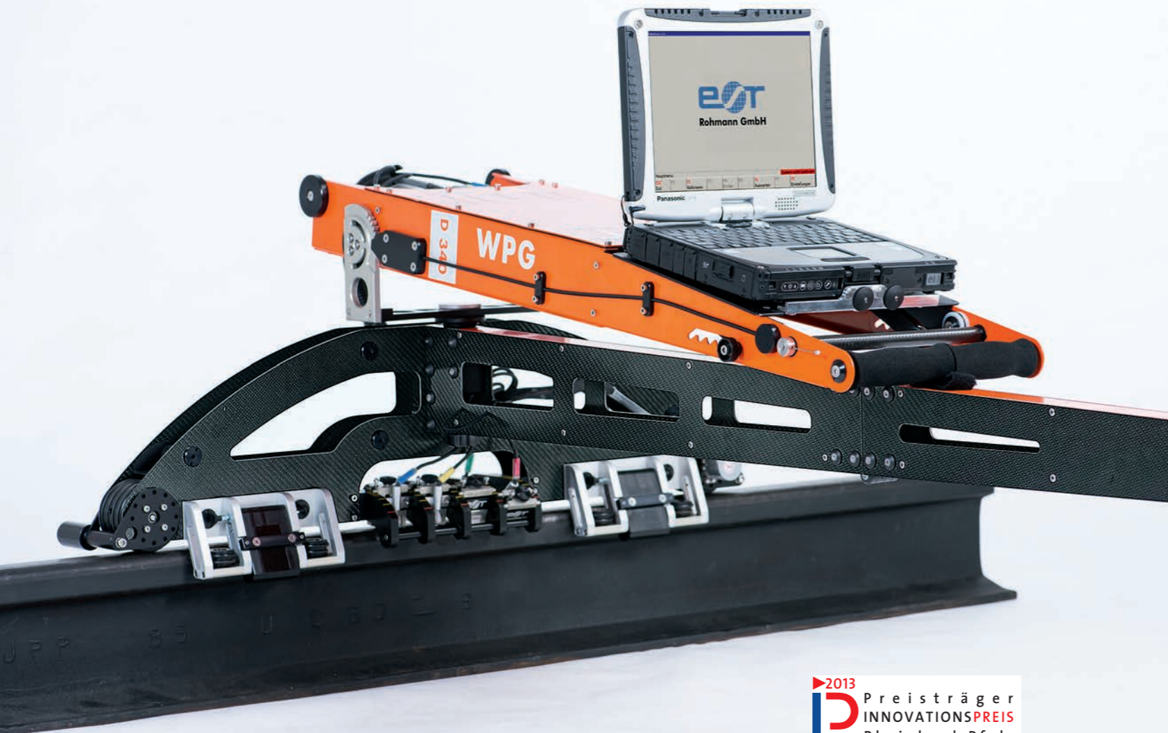
Datenerfassung und Echtzeit-Aufzeichnung von Rohdaten zur Auswertung der Schädigungstiefen
